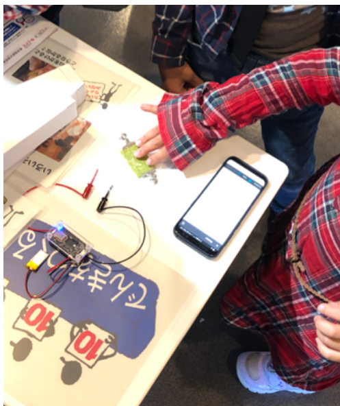
図 4 布状熱電変換モジュールの出力電圧をBluetooth経由でスマートフォンに表示させるデモンストラーション (2018 NAIST オープンキャンパスにて)
