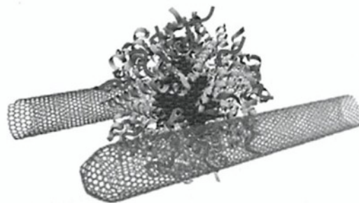
図5 無機粒子を内包したかご状タンパク質分子で CNT が橋渡しされた接合部の模式図. かご状タンパク質分子の主鎖の隙間から見えているものが内包された無機粒子である.
